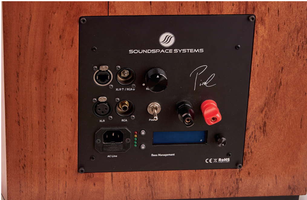
Das Bassmodul der Pirol: Mit dem Drehregler unten links lässt sich der Basspegel einstellen. Mit dem geriffelten Drehknopf oben wird bestimmt, wie stark das nach hinten abstrahlende Hochton-Bändchen ins Geschehen eingreift
