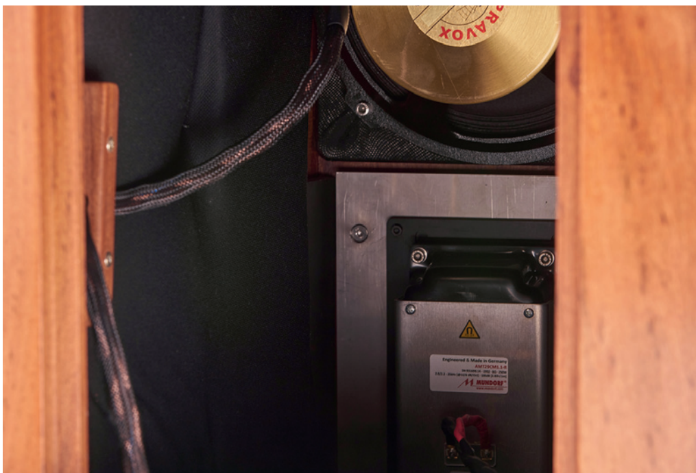
Tiefmittel- und Hochtöner wurden möglichst dicht beieinander montiert, um recht geringe Hörabstände zu ermöglichen
